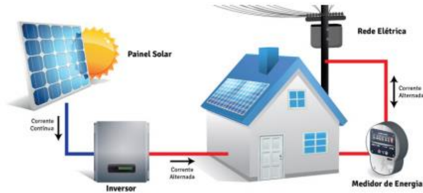
Figura 2 – Esquema de funcionamento do sistema on grid
