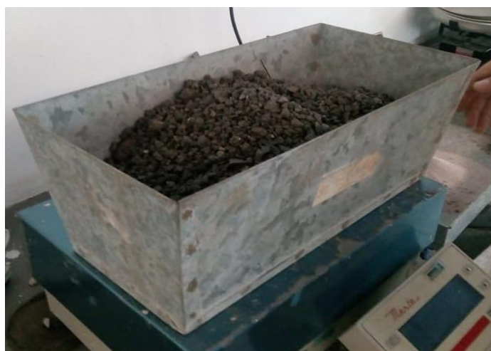
Figura 3 – Pesagem da brita/pedra
