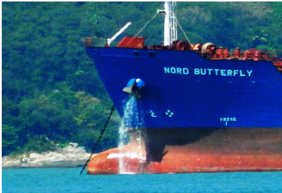
Figura 04 – Esvaziamento dos Tanques de Lastro e Emersão do Casco (Diminuição do Calado)
