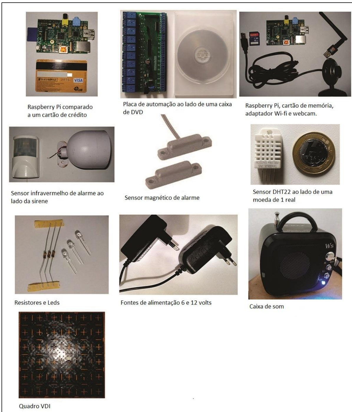
Figura 14 – Componentes utilizados para montagem do sistema de automação
