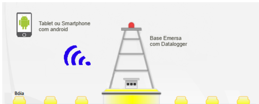
Figura 7: Diagrama Esquemático – Comunicação entre dispositivo móvel e base emersa.
