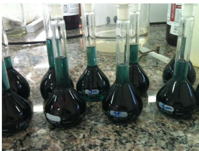
Figura 8. Balões com reagente O-toluidina e o líquido decantado depois da ebulição 95-100°C
