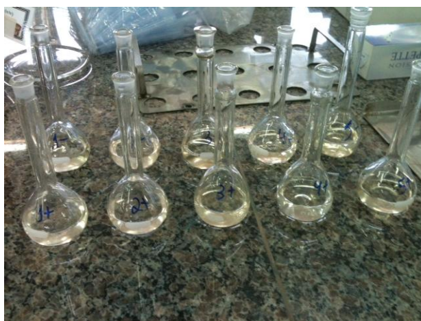
Figura 7. Balões com reagente O-toluidina e o líquido decantado antes da ebulição 95- 100°C.
