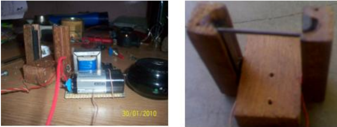
Figura :5 Passos da montagem do microfone de carvão
