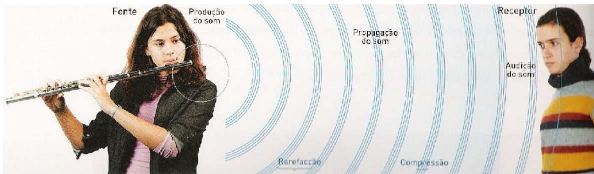
Figura :1 Esquema de propagação das ondas sonoras
